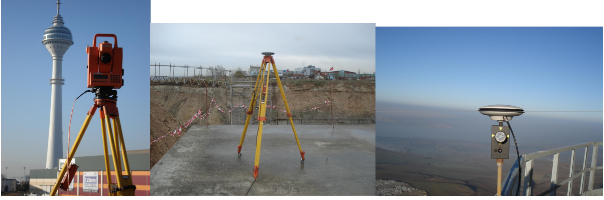
Şekil 2 Totalstation ile izleme, referans GPS istasyonu, hareketli obje noktası
