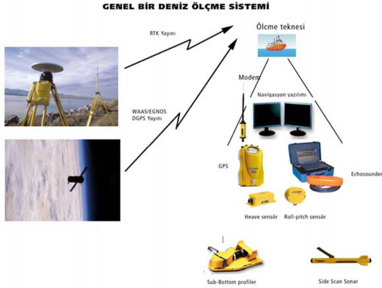
Şekil 2. Genel bir Deniz Ölçme Sistemi
