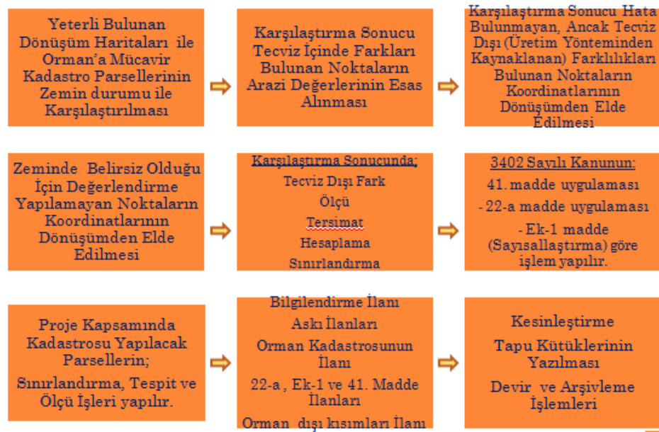
Şekil 2. Orman kadastro çalışmalarında ölçme işleri (Şekil 1'in devamı)
