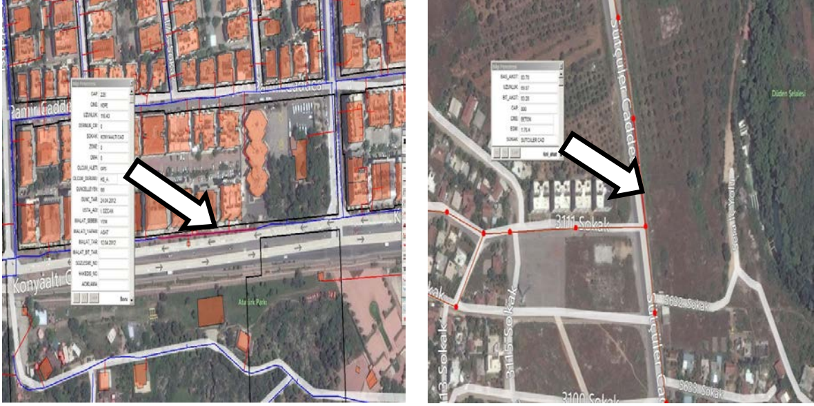
Şekil 2: İçmesuyu ve kanalizasyon şebekesinden öznitelik bilgisi alınması.
