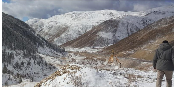
Şekil 3: Poligon noktalarının ölçümüne ait bir görüntü
