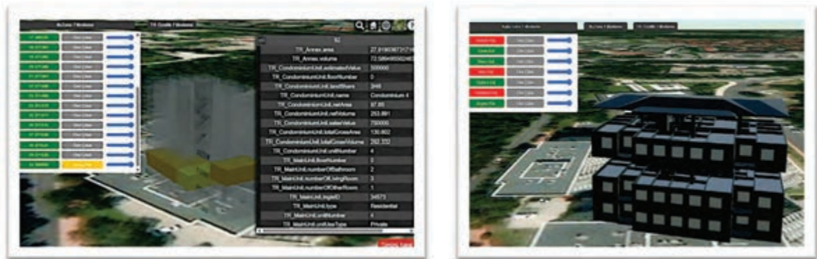
Şekil 7: IFC2x3 Bina Modelinin Farklı Özniteliklere Göre WebCBS Ortamında Filtrelenmesi
