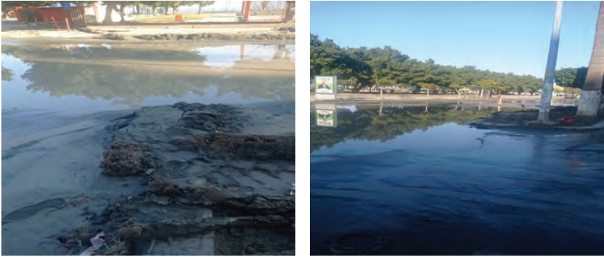
Şekil 33. Hatay-İskenderun ilçesinde sıvılaşma sonrası yeraltı suyu çıkışı
