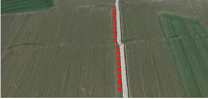
Şekil 1. Narlı fayı üzerinde Narlı-Çiğdemtepe arasında yüzey kırığı ve sol yanal yer değiştirme (HGM, Küre uygulaması Ortofoto üzerinden alınmıştır).
